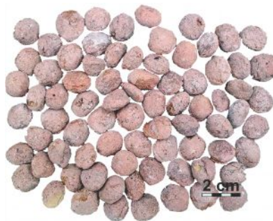
Rys. 12. Sztuczne kruszywa lekkie (wg technologii IMBiGS) wyprodukowane z mieszaniny z udziałem mułów poflotacyjnych
