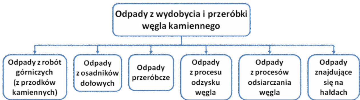
Rys.1. Podział odpadów z wydobycia i przeróbki węgla kamiennego
